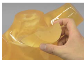
TLD eller RPL dosimetre kan settes i skjoldbruskkjertelblokken.
