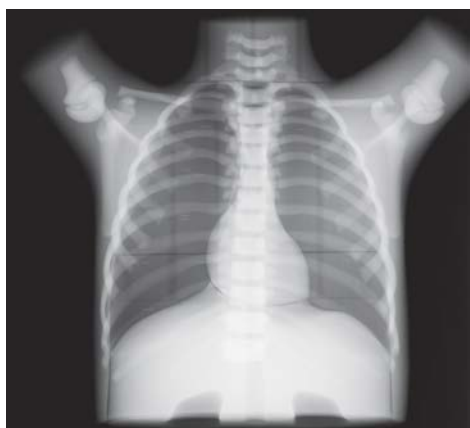
TLD eller RPL dosimetre kan settes i skjoldbruskkjertelblokken.
